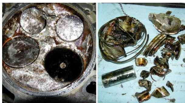
Рис.5. Главный признак поломки клапана вследствие дефекта ремонта (сборки) – отсутствие головки клапана в седле (слева) и разрушение поршня (справа), при наличии подтверждающих признаков – отсутствии разрушения пальца и шатуна, а также следов касания клапанов и поршней.
