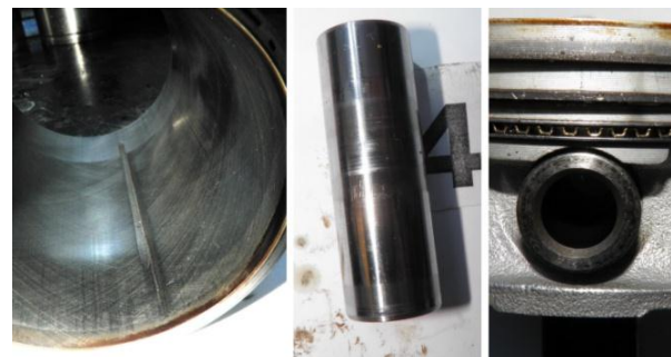
Рис.10. Типичные признаки нарушения осевой фиксации поршневого пальца в шатуне – канавка от пальца на поверхности цилиндра (слева, главный признак), несимметричный контакт поршневого пальца (в центре) и поврежденная торцевая поверхность пальца (справа)
