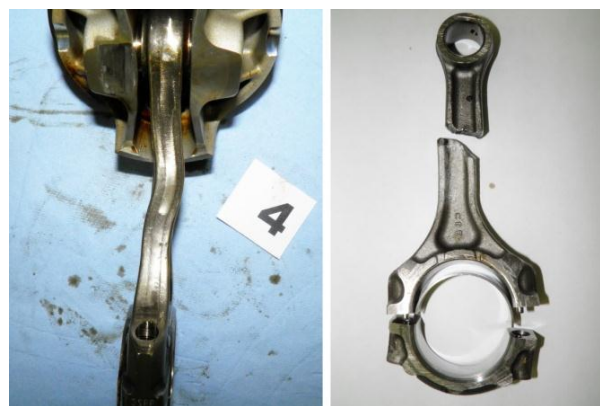
Рис.2. Шатун, деформированный при гидроударе (слева), неизбежно разрушится по стержню через определенное число циклов (справа)
