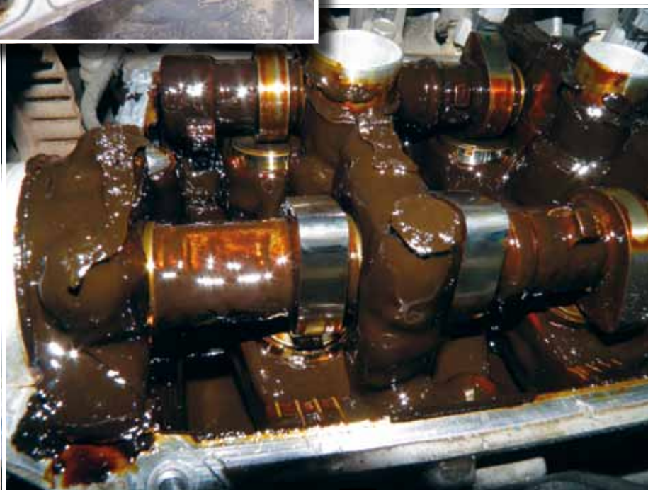
□ В головке блока видны только кулачки распределов и толкатели — все остальное скрыто под толстым слоем «гуталина»
